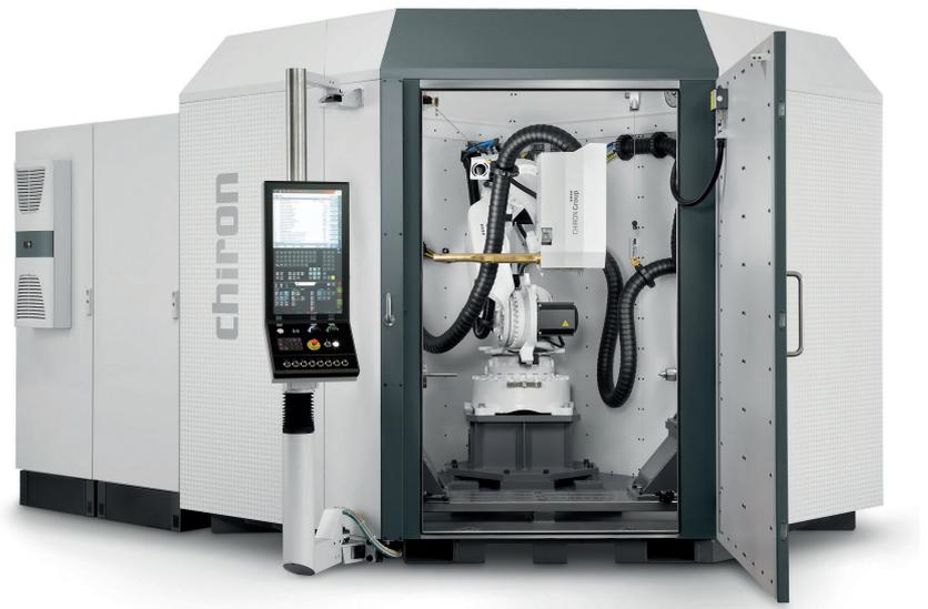
3 Dem AM Cube ist es egal, ob das Ausgangsmaterial Draht oder Pulver ist: Ursache für diese Flexibilität beim 3D-Drucken oder Beschichten von innen oder außen ist der automatische Auftragskopfwechsel © Chiron Group
