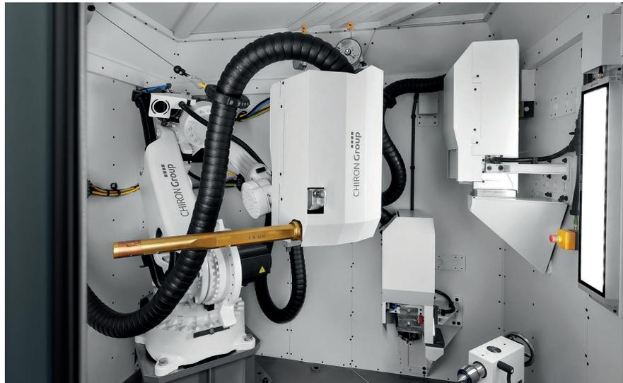
5 Einer der drei Auftragsköpfe des AM Cube beim Auftrag von Pulver mittels Lanze zur Innenbeschichtung von Bauteilen. Die insgesamt drei Auftragsköpfe erlauben den Wechsel des Auftragsmaterials – Draht oder Pulver – in unterschiedlichen Phasen der Produktion
