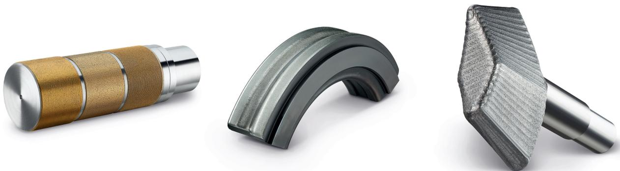
4 Weitere Anwendungsbeispiele: Schweißversuch mit Alubronze zum Ermitteln der Prozessparameter an einer Magnetbremse für Schienenfahrzeuge (links); Kabelführung mit Verschleißschutzbeschichtung aus Stellite 6 (Mitte), Knetzahn mit Beschichtung aus Wolframkarbid (rechts) © Chiron Group
